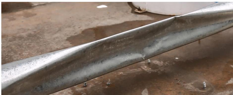
**Figura A2.14** Colapso de una tubería causado por la depresión originada por un golpe de ariete. Cortesía de Eduardo Rodal
