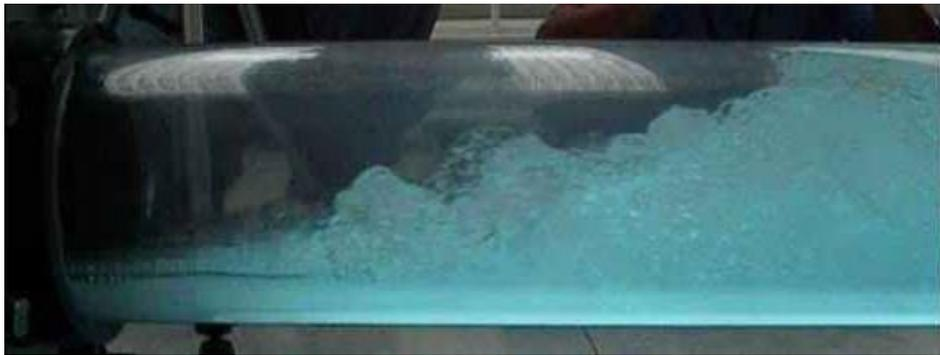
**Figura A2.13** Fenómeno de separación de la columna líquida causado por un golpe de ariete. Cortesía de Eduardo Rodal
