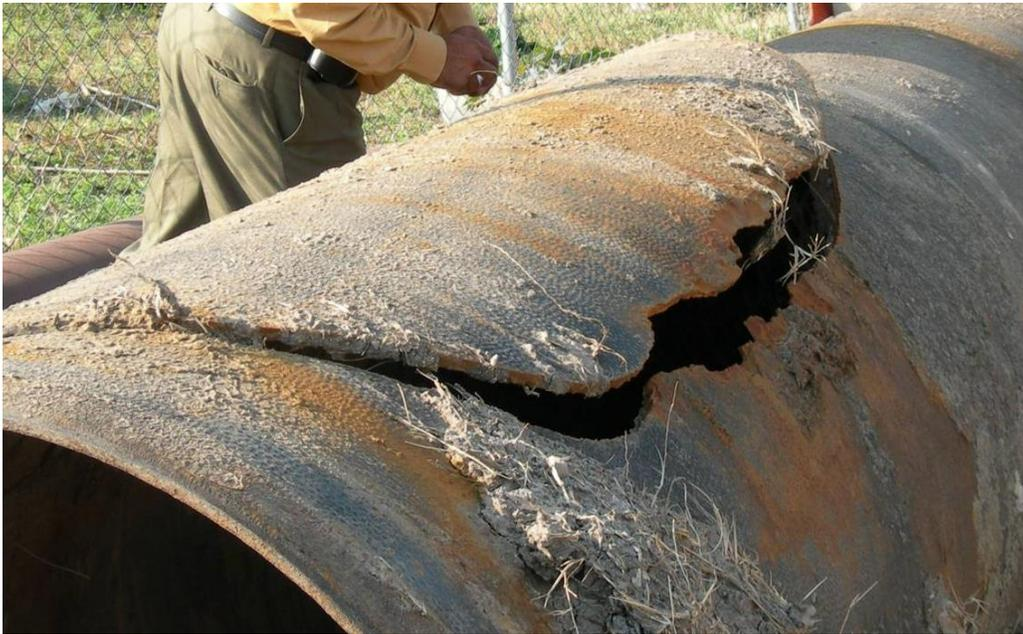
**Figura A2.15** Falla en una tubería causada por un golpe de ariete. Cortesía de Eduardo Rodal
