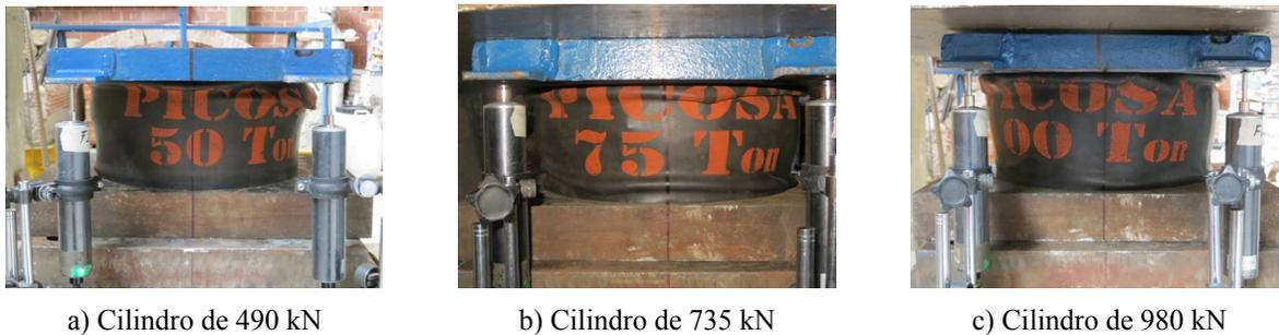
**Figura 6.27** Cilindros poliméricos ensayados
