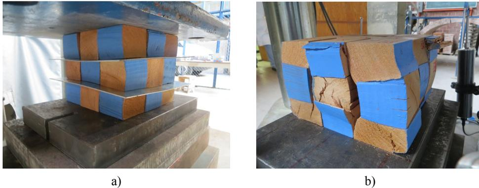
**Figura 6.15** Comparación de deformación de arreglos de  $3 \times 3$  cubos: a) con láminas galvanizadas, y b) sin láminas galvanizadas
