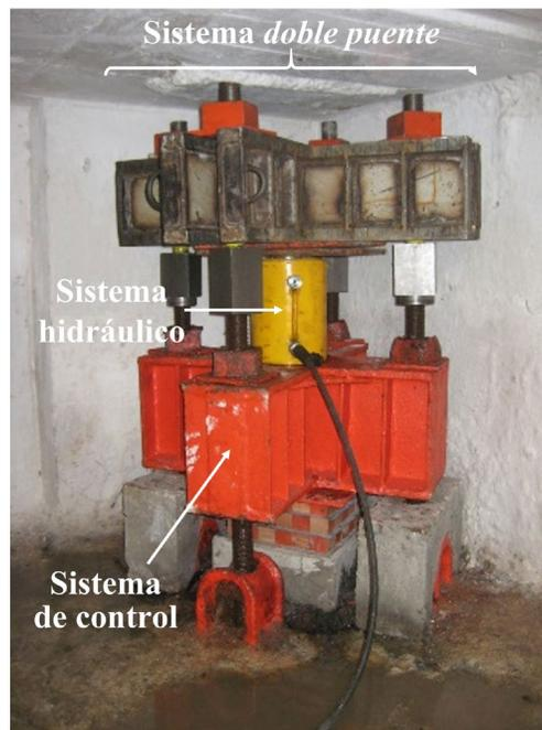
**Figura 3.3.** Sistema *doble puente* utilizado para precargar un pilote de control con cabezal doble
