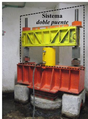
**Figura 4.8.** Sistema *doble puente* con equipo hidráulico utilizado para precargar un pilote de control con cabezal tradicional
