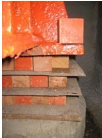
b) Cubos de la celda de deformación sueltos
