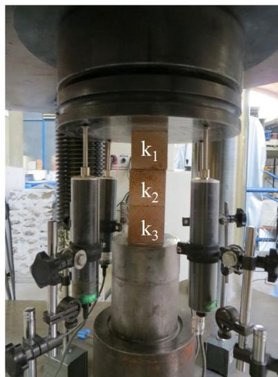
**Figura 6.21** Evaluación de las propiedades mecánicas de un *arreglo en serie*
