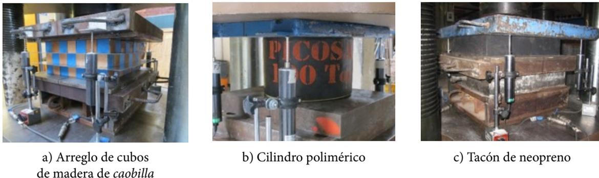
**Figura 6.1** Celdas de deformación ensayadas en laboratorio
