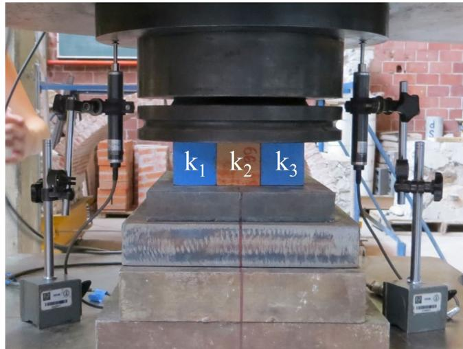
**Figura 6.20** Evaluación de las propiedades mecánicas de un *arreglo en paralelo*
