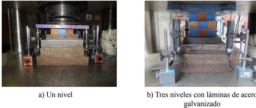
**Figura 6.13** Deformación de arreglos de  $3 \times 3$  cubos
