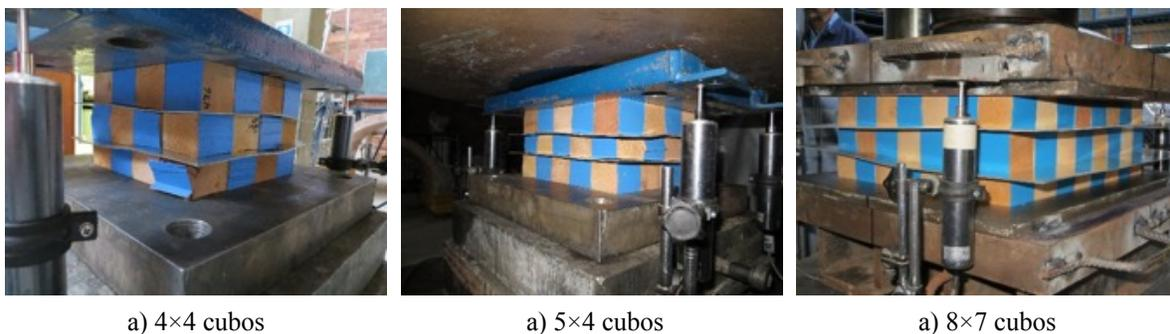
**Figura 6.17** Deformación en distintos arreglos de tres niveles de  $m \times n$  cubos con láminas galvanizadas
