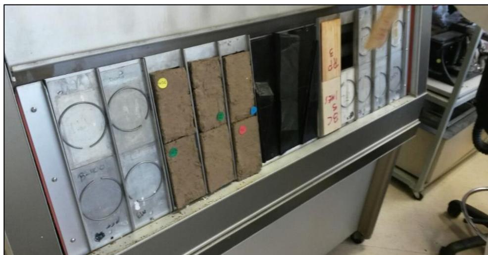
**Figura 5.10** Cámara de intemperismo acelerado Marca: The Q-LAB Panel Co. Modelo QUV (Cleveland, EE. UU.)
