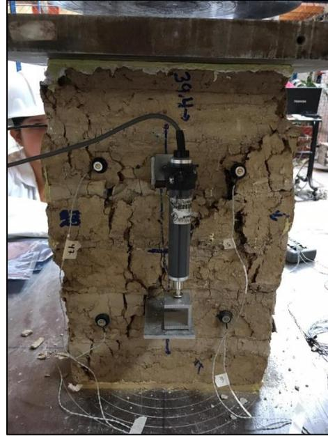
**Figura 6.38** Pila observa falla (Lado B)
