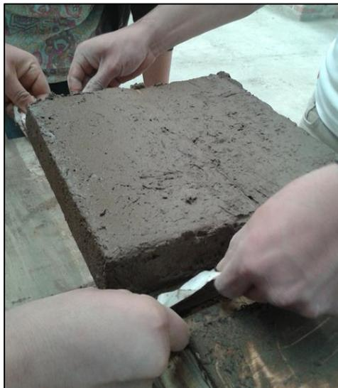
**Figura 6.17** Bordes laterales para sujetar y desplazar el ladrillo
