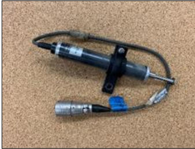
**Figura 6.28** Transductores de desplazamiento: Dispositivos de medición. Capacidad 25mm. Peso 100 g. Respuesta de frecuencia 8Hz. Voltaje excitante recomendado 2V o menos
