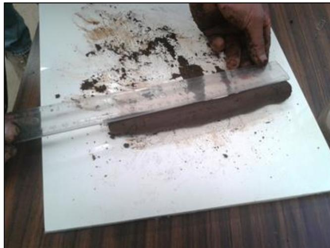
**Figura 2.4** Medición de la longitud de rotura
