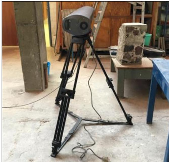
**Figura 6.27** Certus HD: Realiza el seguimiento dinámico del movimiento con ayuda de los Led's infrarrojo, para así dar la posición. Frecuencia máxima de muestreo (frecuencia del marcador) 4,600
