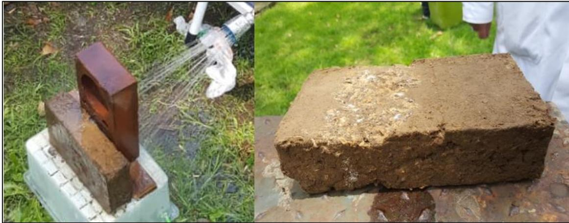
**Figura 5.11** Prueba de resistencia a la erosión
