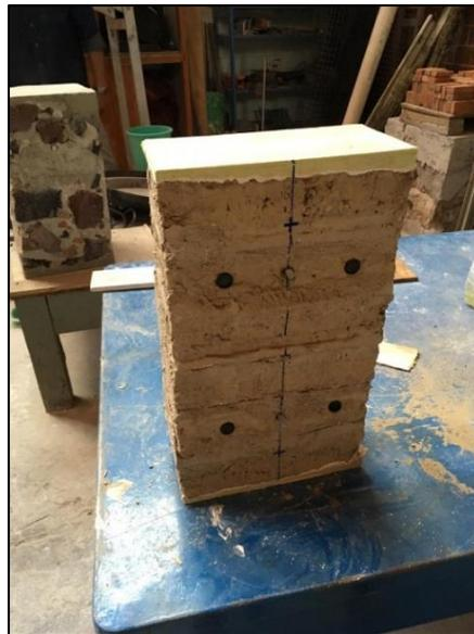
**Figura 6.33** Pila cabeceada para pruebas
