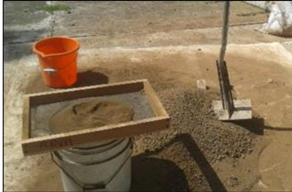
**Figura 6.2** Apisonado de los residuos de excavación
