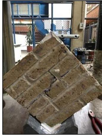
**Figura 6.31** Se observa la falla a 1207.1 (kg) (Lado B).
