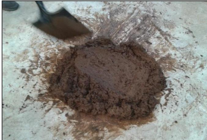
**Figura 6.10** Homogenización de la mezcla
