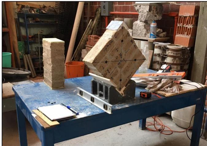
**Figura 6.29** Murete listo para las pruebas
