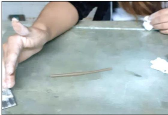
**Figura 5.5** Moldeo de cilindros de material
