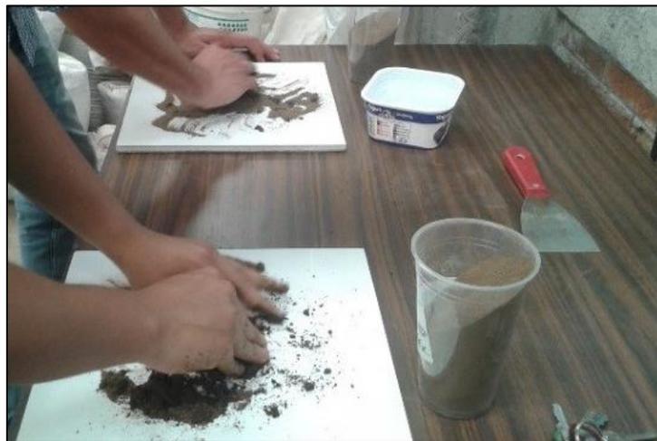
**Figura 2.5** Moldeo de la porción de material de excavación para realizar la prueba de dureza
