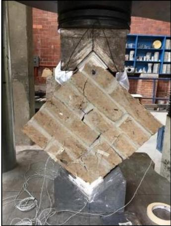
**Figura 6.30** Se observa la falla a 1207.1 (kg) (Lado A).
