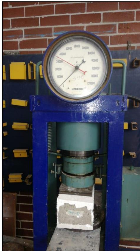
**Figura 5.9** Prensa para ensayos de compresión
