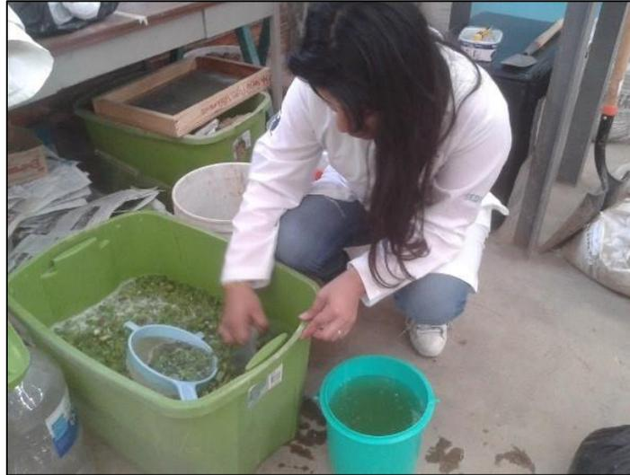
**Figura 3.4** Obtención del mucílago de nopal en la mezcla líquida
