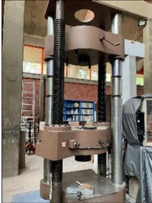
**Figura 6.26** Máquina Universal. Capacidad de 200 Ton: Máquina Universal SATEC (SATEC, 1990). Modelo 500WHVL. Capacidad de 250 t (500,000 lbs). Peso estimado 11 t (22,000 lbs). Requerimientos de energía: 230 Volts, 3 fases, 60 Hertz
