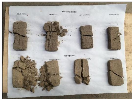
**Figura 6.4** Bloques, combinaciones preliminares probadas. Fuente: Adaptado de (López, 2018).
