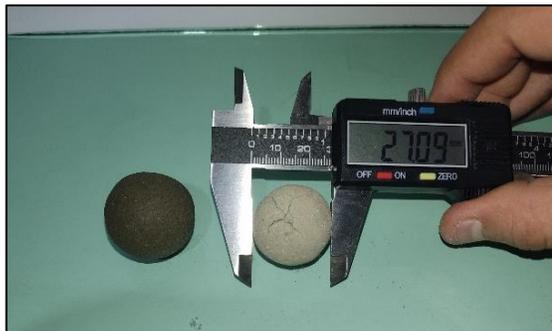
Material con fisuras y con menor volumen, al secarse la mezcla pierde volumen y el material seco empieza a agrietarse el producto de la contracción.
