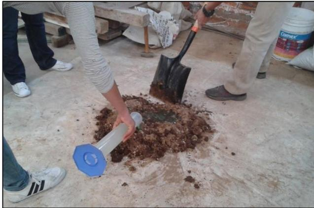
**Figura 6.9** Incorporación de la mezcla agua-mucílago
