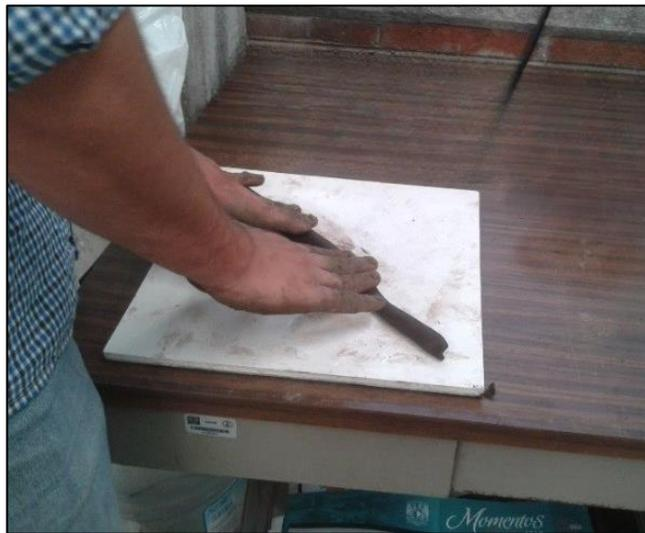
**Figura 2.2** Elaboración de cilindro con el material de excavación
