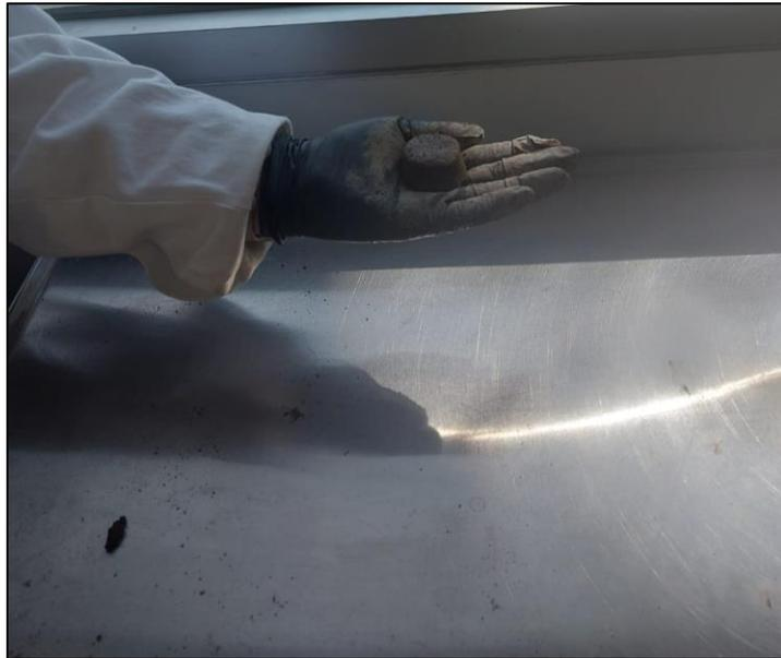
**Figura 2.6** Pastillas moldeadas con residuos de excavación
