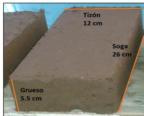
**Figura 6.5** Dimensiones de fabricación
