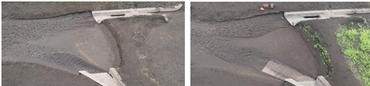
**Figuras 3.17** Sin coraza (izquierda), con coraza (derecha). *Fuente: foto tomada por el autor*
