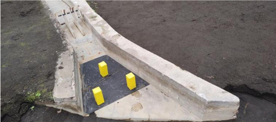
**Figura 3.8** Estructura deflectora con pilas de 0.05 m de lado. *Fuente: foto tomada por el autor*
