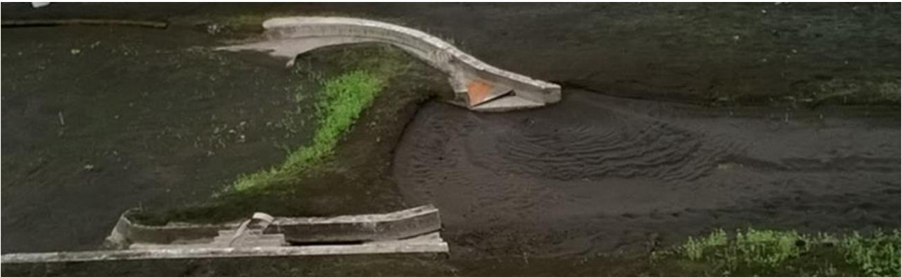
**Figura 3.7** Fosa producida por la rampa deflectora sin pendiente en el lado derecho. *Fuente: foto tomada por el autor*
