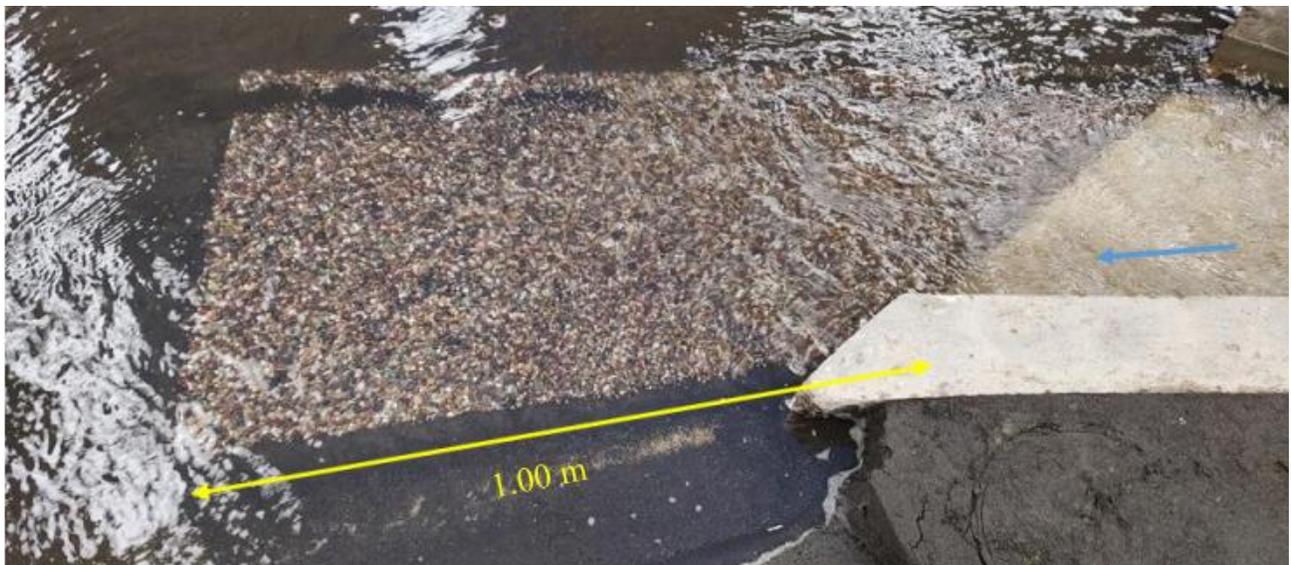
**Figura 3.15** Condiciones de la superficie acorazada, casi al final del experimento. Fuente: foto tomada por el autor
