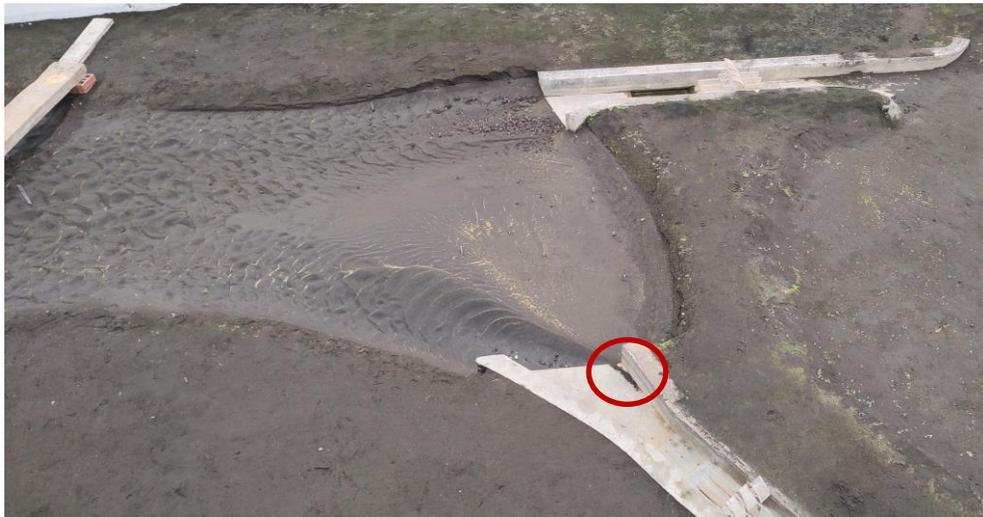
**Figura 3.2** Erosión local sin ningún tipo de estructura deflectora o coraza en el CMI. *Fuente: foto tomada por el autor*
