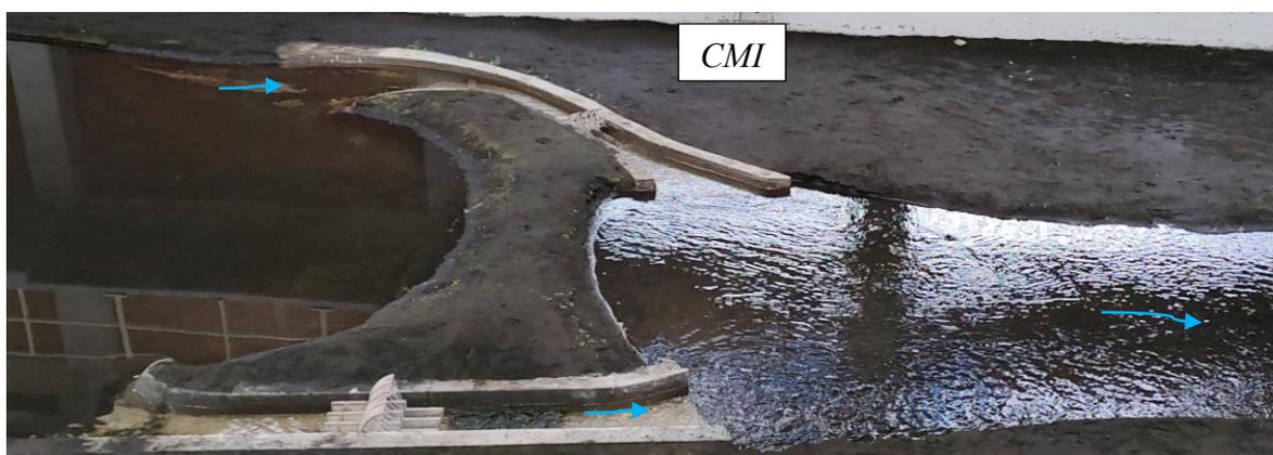
**Figura 1.4** Modelo físico de la estructura de control El Macayo. *Fuente: foto tomada por el autor*
