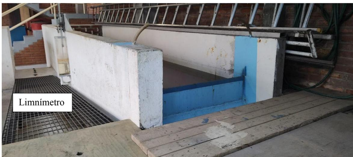
**Figura 1.3** Vertedor y limnómetro empleados para aforar el caudal que ingresa al modelo. *Fuente: foto tomada por el autor*
