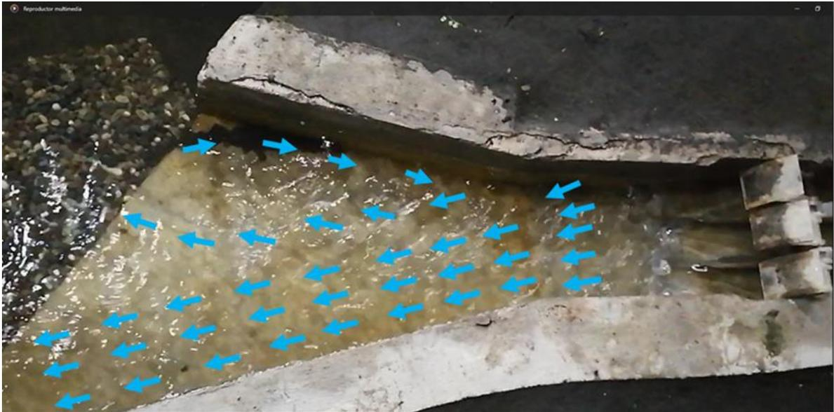
**Figura 1.6** Esquema de la distribución de velocidades en la zona de separación del flujo. *Fuente: foto tomada por el autor*
