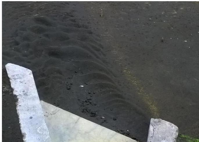
**Figura 3.9** Fosa de erosión obtenida con las pilas de 0.05 m de lado. *Fuente: foto tomada por el autor*
