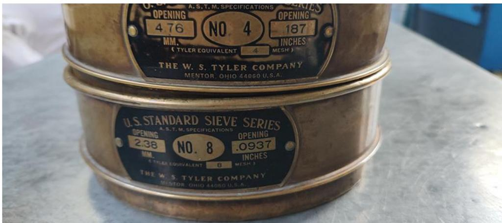
**Figura 3.12** Charolas empleadas para seleccionar el tamaño del material de la coraza. Fuente: foto tomada por el autor
