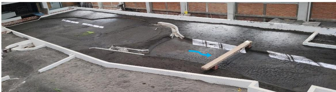
**Figura 1.2** Superficie ocupada por el modelo físico de la estructura de control el Macayo. *Fuente: foto tomada por el autor*
