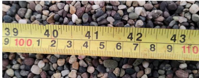
**Figura 3.10** Detalle de la forma y dimensiones de los elementos de la coraza. *Fuente: foto tomada por el autor*
